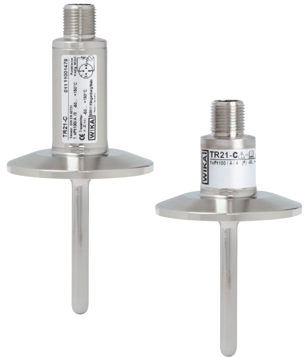
Czujnik rezystancyjny bez szyjki przedłużeniowej model TR21-C z przyłączem typu Clamp Zdj. lewe: sygnał wyjściowy 4 ... 20 mA Zdj. prawe: sygnał wyjściowy Pt100
