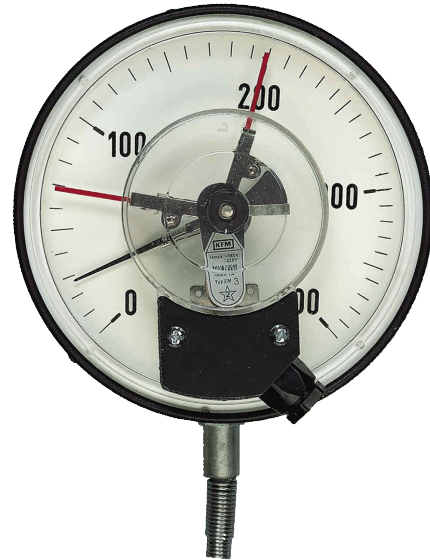
Termometr model TGRO z przystawką kontaktową
