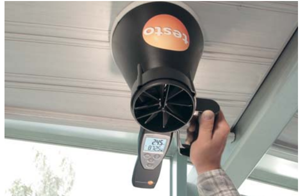
testo 417, np. do kontroli wydatku na kratkach wentylacyjnych
