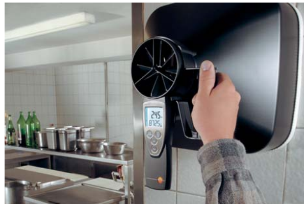
testo 417, np. do monitoringu jakości systemów wentylacyjnych w pomieszczeniach
