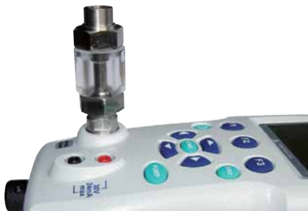
Ręczny kalibrator ciśnienia z zamontowanym z pułapką brudu
